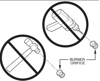
Fig. 61 - Orifice Hole
