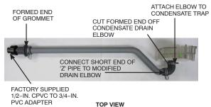
DRAIN ELBOW "Z" DISCHARGE PIPE FOR LEFT SIDE
