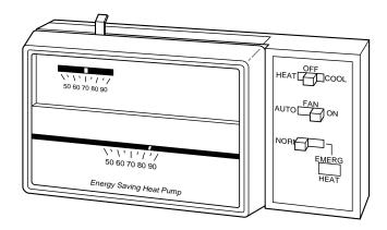
Fig. 2—Manual Changeover Thermostat
